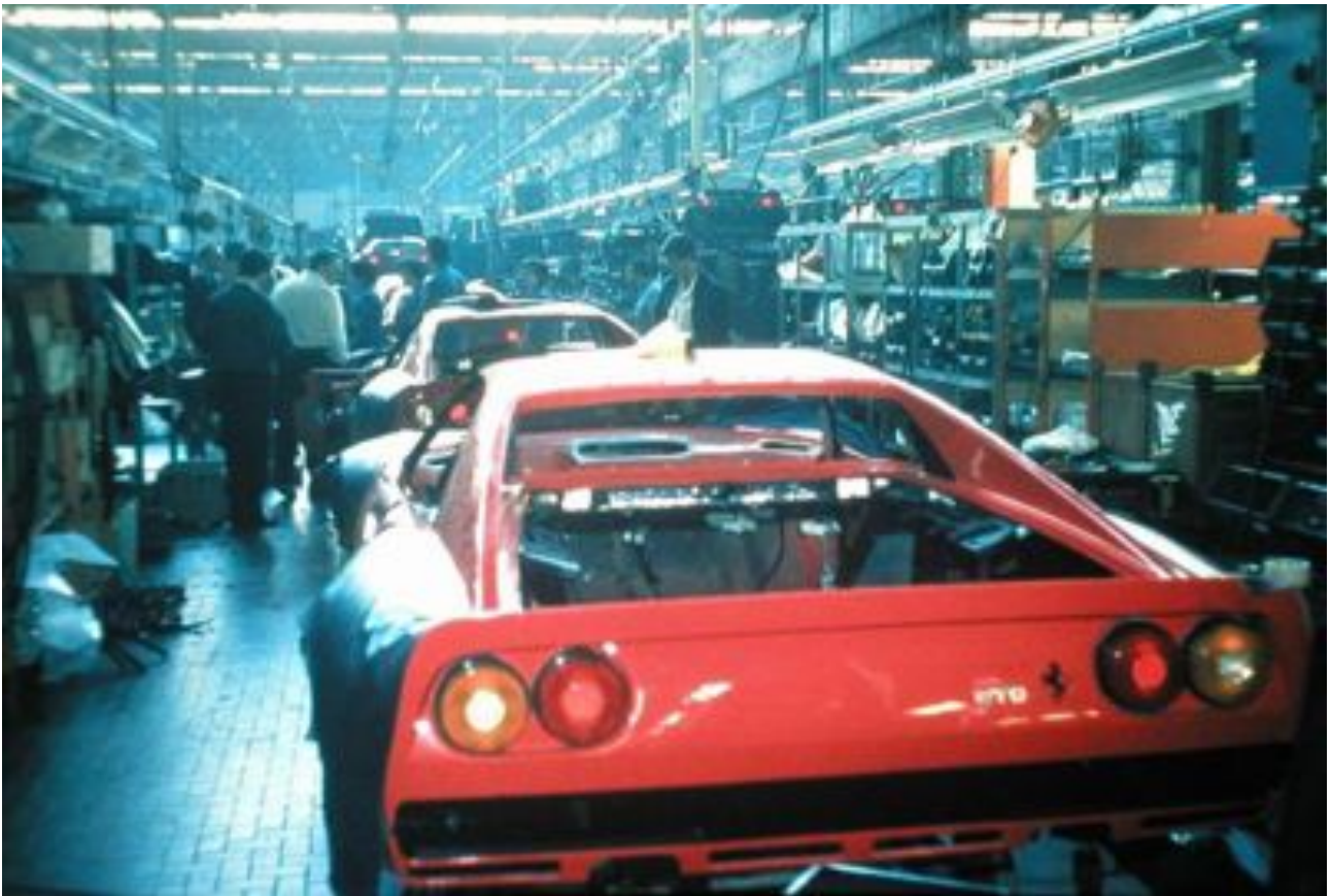
Carrosserie : Fibre de verre base carbone et Kevlar réalisée chez Scaglietti à Modène.
