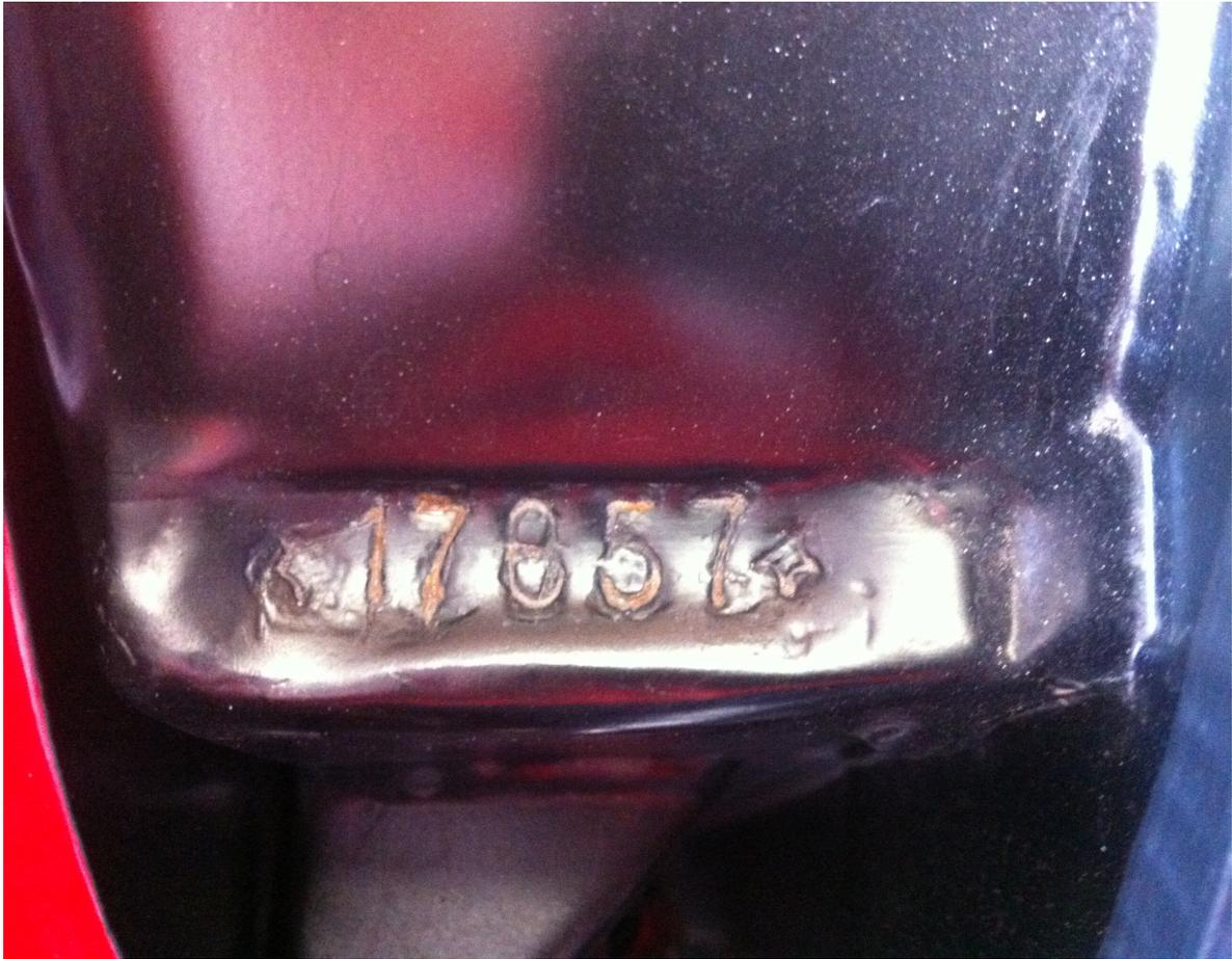
**17857 frappé sur le châssis du côté gauche à l'avant.**
